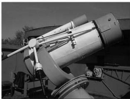
Рис.5 – 50-сантиметровый менисковый телескоп Максутова
