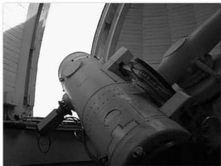
Рис.6 – 70-сантиметровый телескоп АЗТ-8
