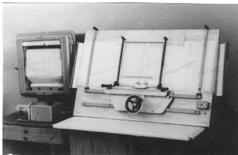
Рис. 15. Полуавтоматическая установка для преобразования измеренных на фотонегативе почернений в интенсивности по характеристической кривой
