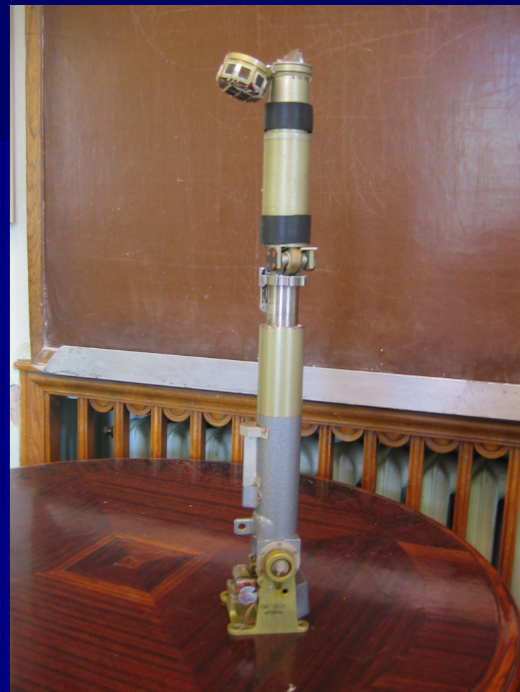
Прибор «Фобос» для измерения диаметров спутников Марса
