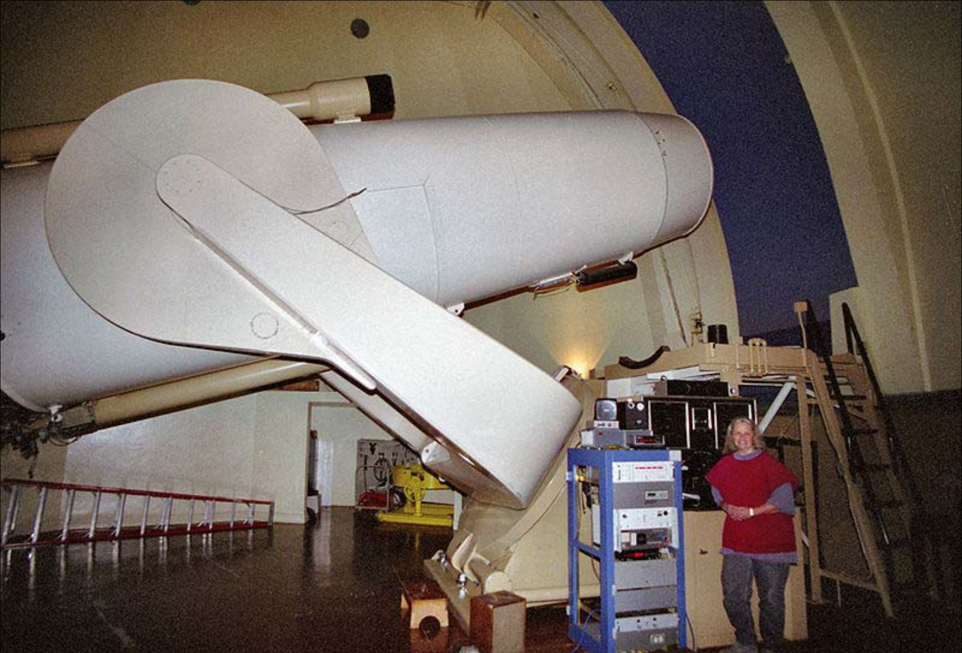
48-дюйм камера Шмидта Паломарской обсерватории (1948 г.) Первый в мире обзорный телескоп
