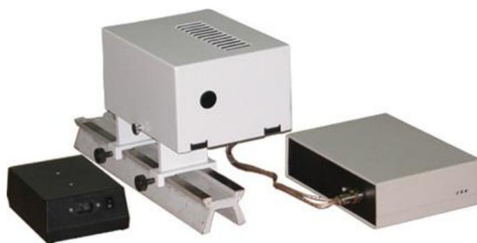
Рис. 4. Осветителя (в центре) и блоки питания ламп
