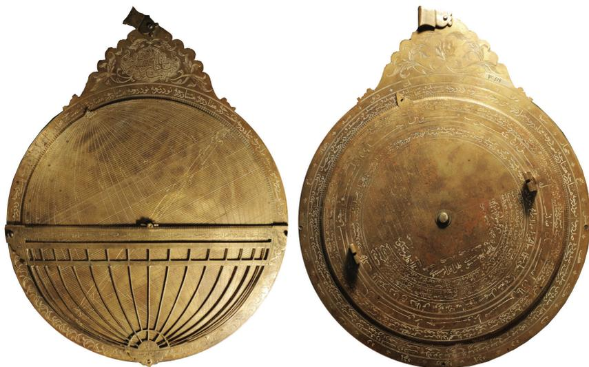
Рис. 5. Астрольбия с ортографической проекцией Хуана де Рохаса. Диск проекции виден на лицевой стороне (слева) под накладной сеткой. Надпись на троне (слева) — посвящение шаху Хусейну. Визирь алидады (справа) вращаются вместе со шкалами
