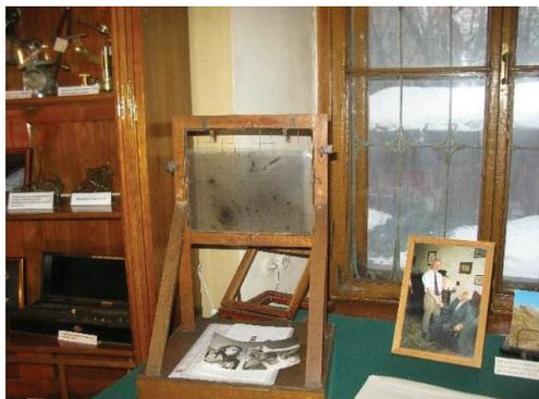
Рис. 23. Рамка с сеткой для просмотра астронегативов (парами) с целью обнаружения на них переменных звёзд. Конструкция В.К. Цераского, 1895 г.
