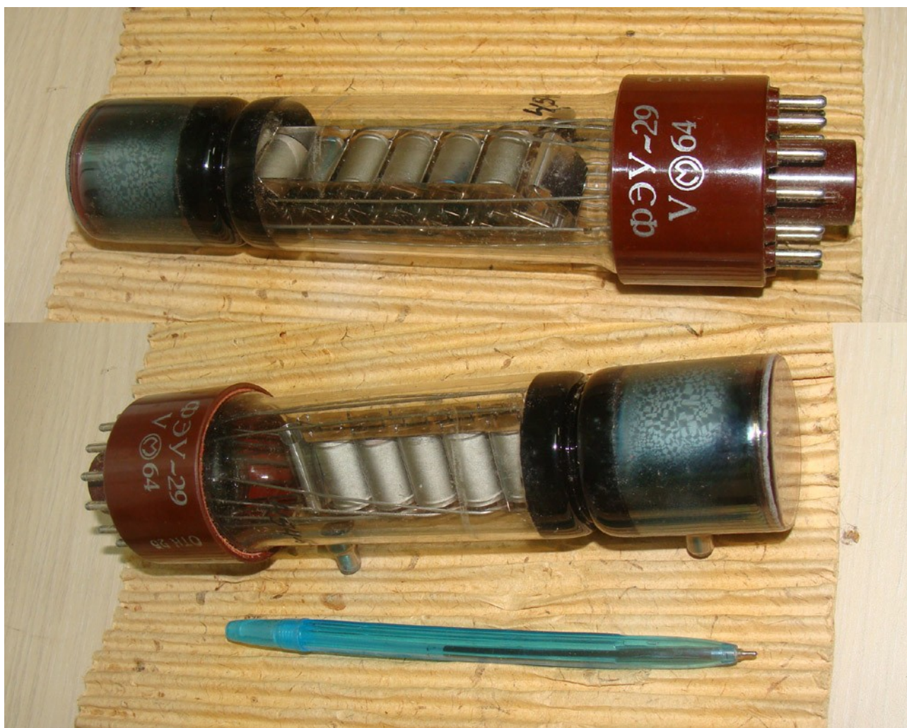
Рис. 1 Фотоумножитель ФЭУ-29. Хорошо видна система динодов.
