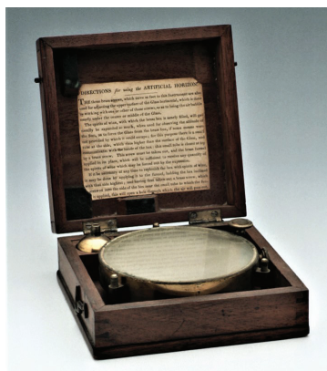
Рис. 5. Искусственный горизонт П. Доллонда. Англия, 1820 г.
